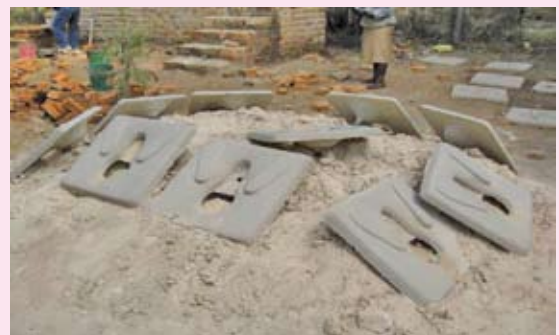
Dalles Ecosan à déviation d'urine en béton fabriquées par les stagiaires
